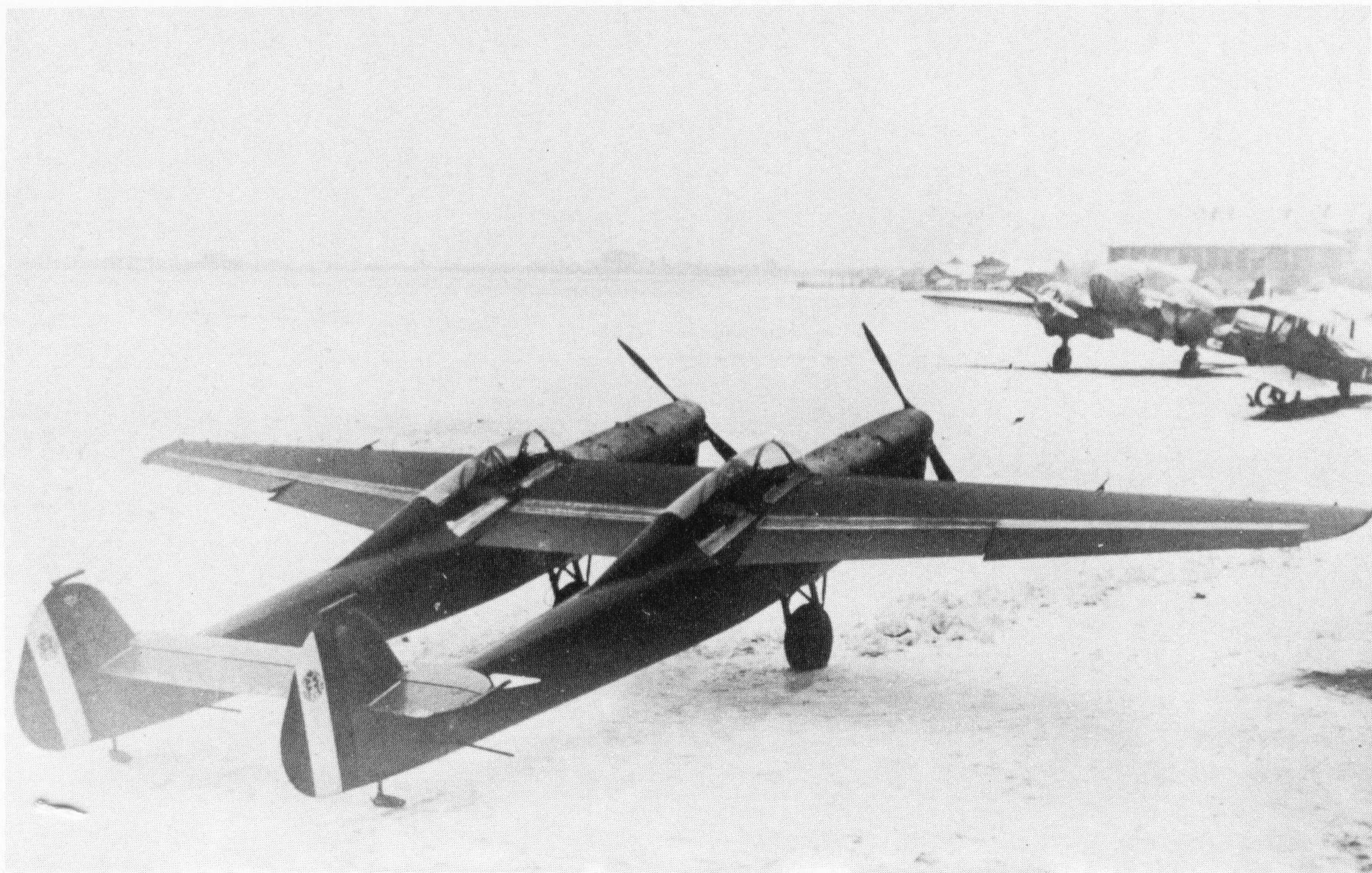
Un bimotore tradizionale ed un vecchio «Caproncino» fanno risaltare tutta l'eccezionalità del bi-fusoliera Bestetti-Nardi BN.1. In esso il progettista impiega legno ricostituito «come fornitore di fibre e non di pezzi».
