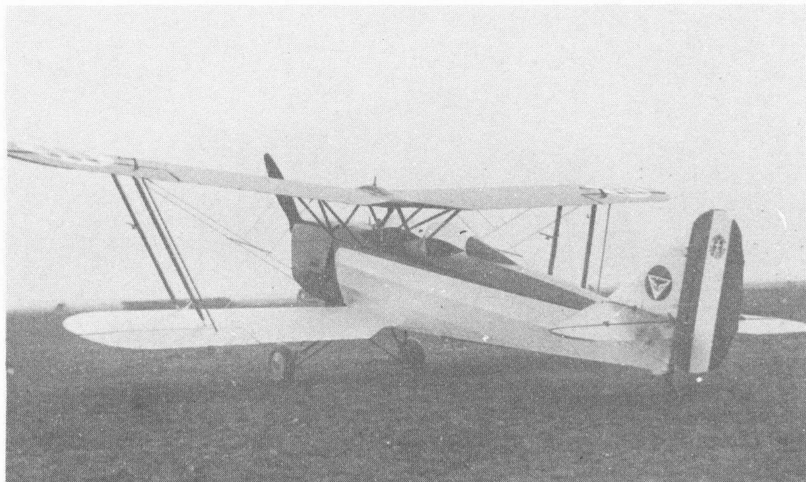
Il primo C.5 B (biposto) /Alfa costruito dalla CANSA. Si vede chiaramente la caratteristica soluzione biplana propria dell'Harriot con l'ala superiore a diedro positivo.
