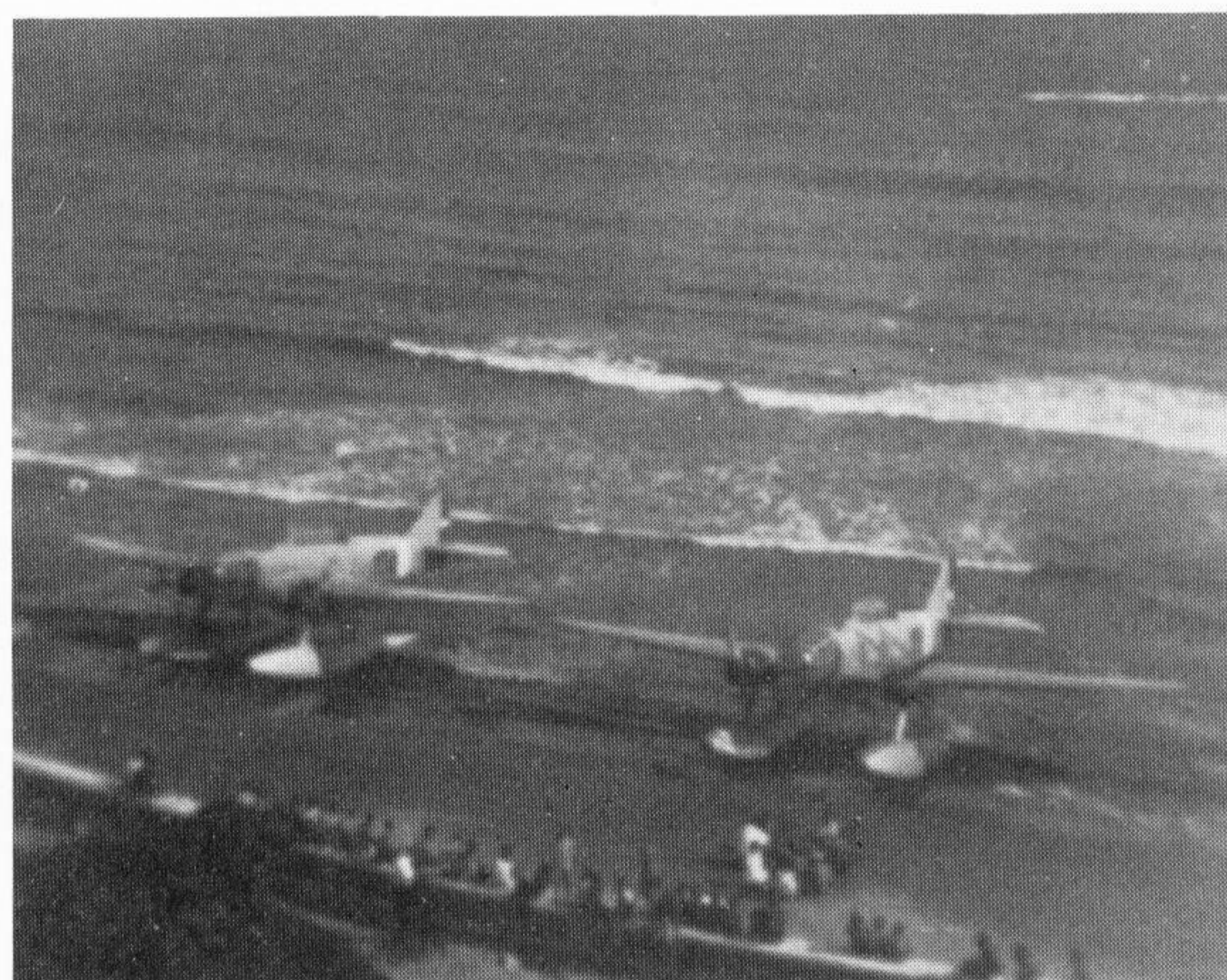
Coppia di SIM-XIV costretta ad ammarare ad Anzio nell'estate del 1941 durante il volo di trasferimento da Cattaro a Orbetello. Trattasi di un esemplare della «Serie O» (ad ala controventata) e di uno della «Serie I» (ad ala a sbalzo).
