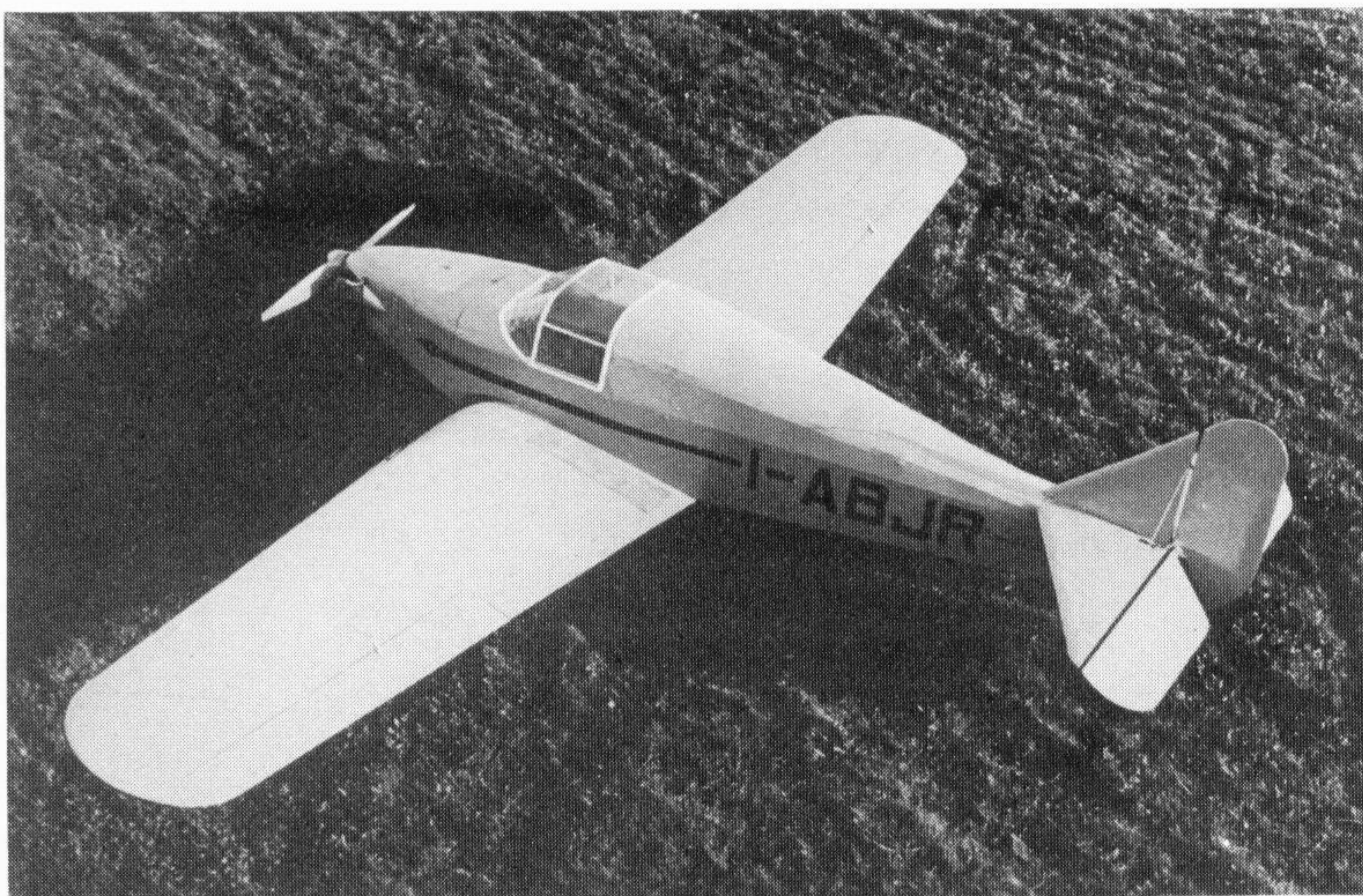
Il primo L.3 presenta unità motrice di tipo straniero, estremità alari ancora arrotondate, timone verticale non compensato aerodinamicamente, abitacolo chiuso da cappottina incernierata e ribaltabile sul fianco destro.
