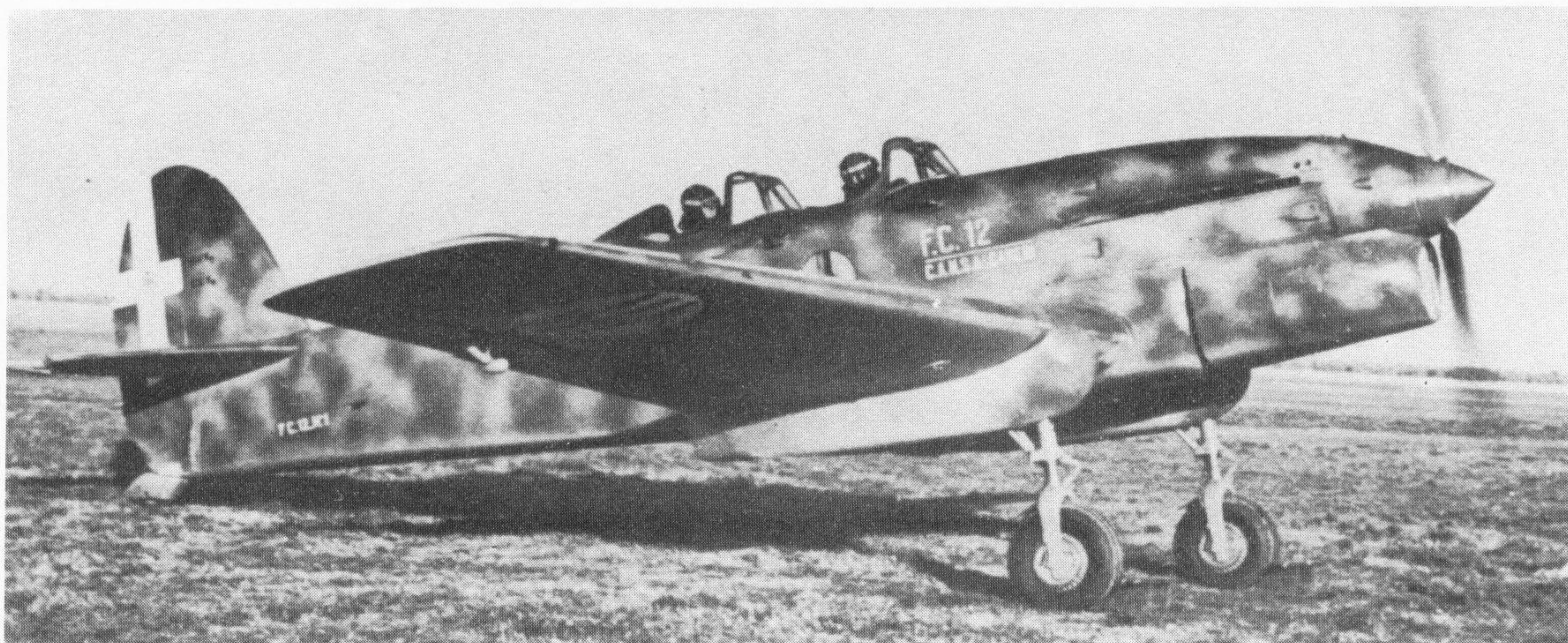
Il prototipo del CANSA FC.12 nella primitiva configurazione ad abitacoli aperti. Questo aereo nasce per privata iniziativa della Ditta novarese ma non viene accettato dalla Regia Aeronautica.
