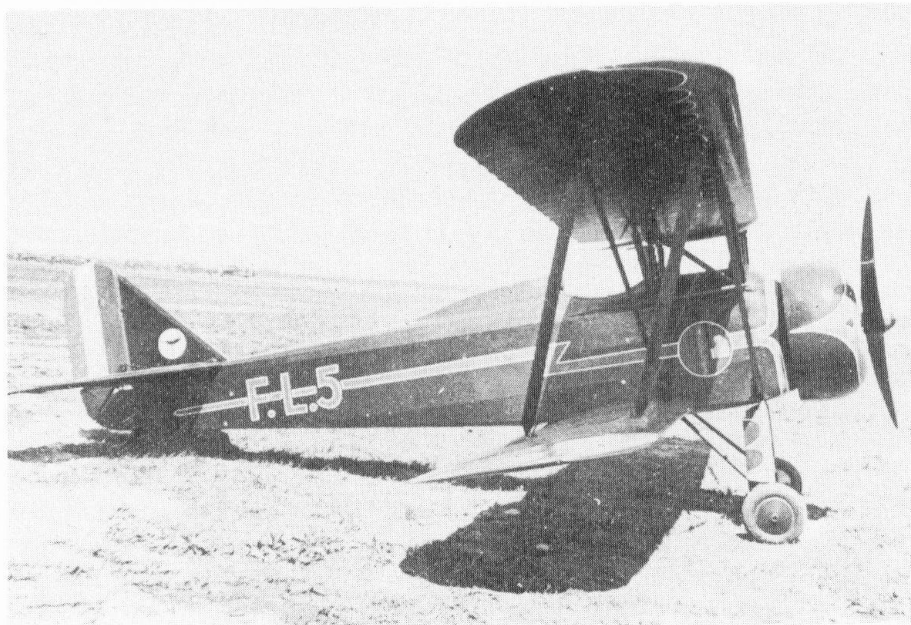
Il prototipo CANSA con motore Fiat A.50 è chiamato inizialmente FI.5 e poi definitivamente C.5. È un omaggio a Francis Lombardi che per primo ha ricondizionato un Hanriot originale con il motore Fiat.
